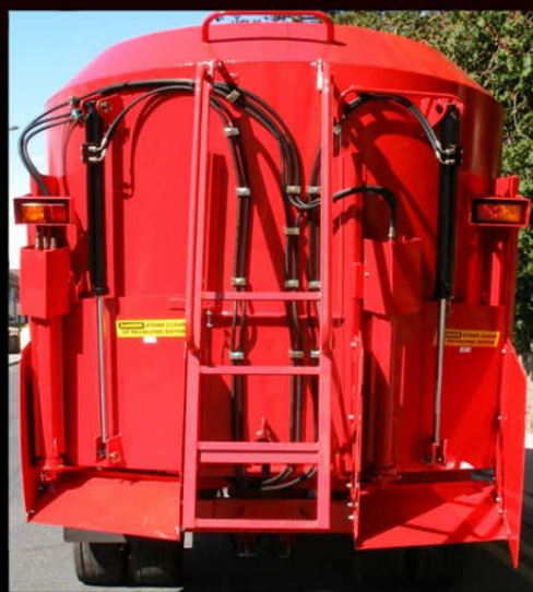
Dvojité zadné dvere s priamymi podávacími sklzmi (odkaz: možnosti podávania 1,5/1,6 alebo 2,7/2,8)
