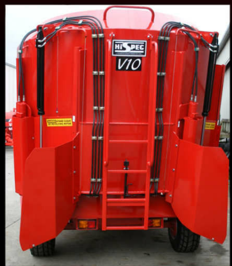
Dvojité zadné dvere s priamymi podávacími sklzmi (odkaz: možnosti podávania 1,5/1,6 alebo 2,7/2,8)
