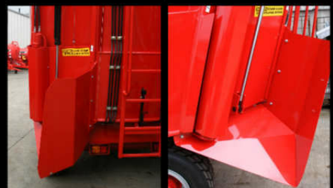
Dvojité zadné dvere s priamymi podávacími sklzmi (odkaz: možnosti podávania 1,5/1,6 alebo 2,7/2,8)
