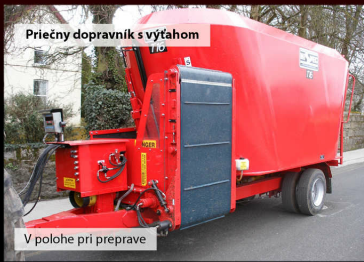
Vnútrotný dopravník umožňuje podávať krmivo zľava aj sprava.
