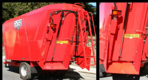
Dvojité zadné dvere s priamymi podávacími sklzmi (odkaz: možnosti podávania 1,5/1,6 alebo 2,7/2,8)
